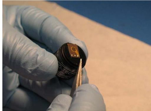
Inserire il gruppo di filtri sopra la cella mantenendoli centrati; assicurarsi che essi siano installati nell'ordine corretto: prima il *Filter Media #2*, poi in cima il *Filter Media #1*, con la parte lucida rivolta verso l'alto.
