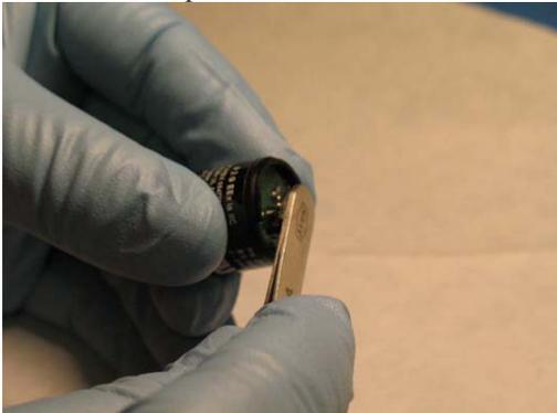
Usando le pinzette inserire nel suo involucro l'intera cella; allineare i piedini con i relativi connettori del sensore e premere fino a che non ne avvenga stabilmente il contatto; verificare che la cella sia allineata alla finestra della lampada.
