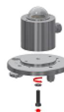
5. Montare il piranometro con il DYA048 sul supporto DYA035, avendo cura di livellarlo orizzontalmente utilizzando la bolla del piatto. Successivamente, fissare il piranometro al disco di supporto usando le due viti più lunghe; utilizzare allo scopo una chiave n° 4.
