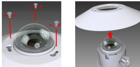
4. Montare il corpo del sensore sul supporto DYA034-035, avendo cura di livellarlo orizzontalmente utilizzando la bolla integrata nel sensore.
